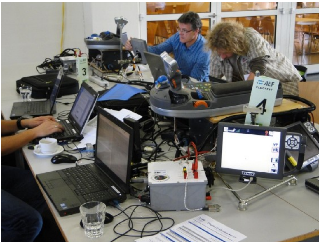
Billede 7. Fysisk test af kompatibilitet mellem terminaler og maskinstyringer. Foto: www.oemoffhighway.com
